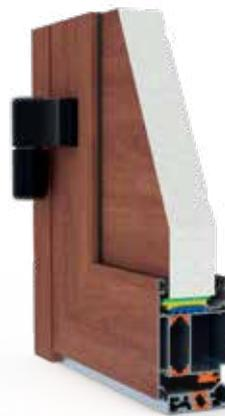
Einflügel-türen sind mit 40 mm starken, wärmege-dämm-ten Torsektionen gefüllt. Basierend auf 60 mm tiefen, thermisch getrennten Profilen.
