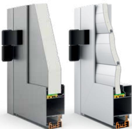
Einflügel-türen sind mit 51 mm tiefen Profilen. Die Flügel-füllung besteht aus den Aluminiumprofilen des Rolltors – oder den Sandwich-Stahlsektionen aus unserem Garagenprogramm mit einer Stärke von 40 mm.
